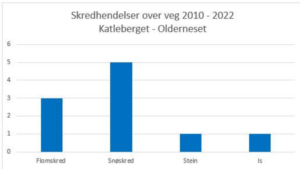
Figur 1 Skredhendelser fordelt på skredtype som er registrert over veg fra 2010 – 2022 mellom Katleberget og Olderneset. Totalt 10 skred er registrert på en strekning på 3 km over en periode på 12 år, dvs. skredfrekvens på 0.8 skred / år.
