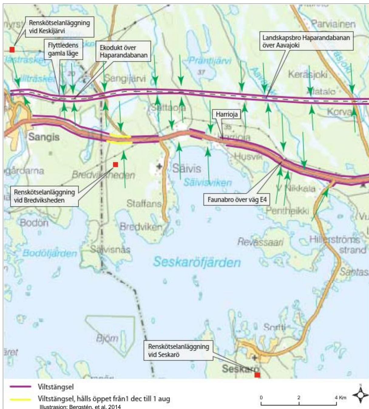
Figur 5-10. Situasjonsbeskrivelse for Liehittäjä samebys flytt- og trekkleier over E4 og Haparandabanan hentet fra Bergstén et al. (2014). Faunabroen ved Harrioja over E4 og øvrige åpne passasjer langs jernbanen og E4 markert med grønne piler. Passasjene består av åpninger i viltgjerder ved bebyggelse og kryssende veger, samt jernbane- og vegbroer over vassdrag eller veger. Faunaovergangen ved Sangis er i illustrasjonen omtalt som en økodukt (Kilde: Bergstén, et al. 2014).
