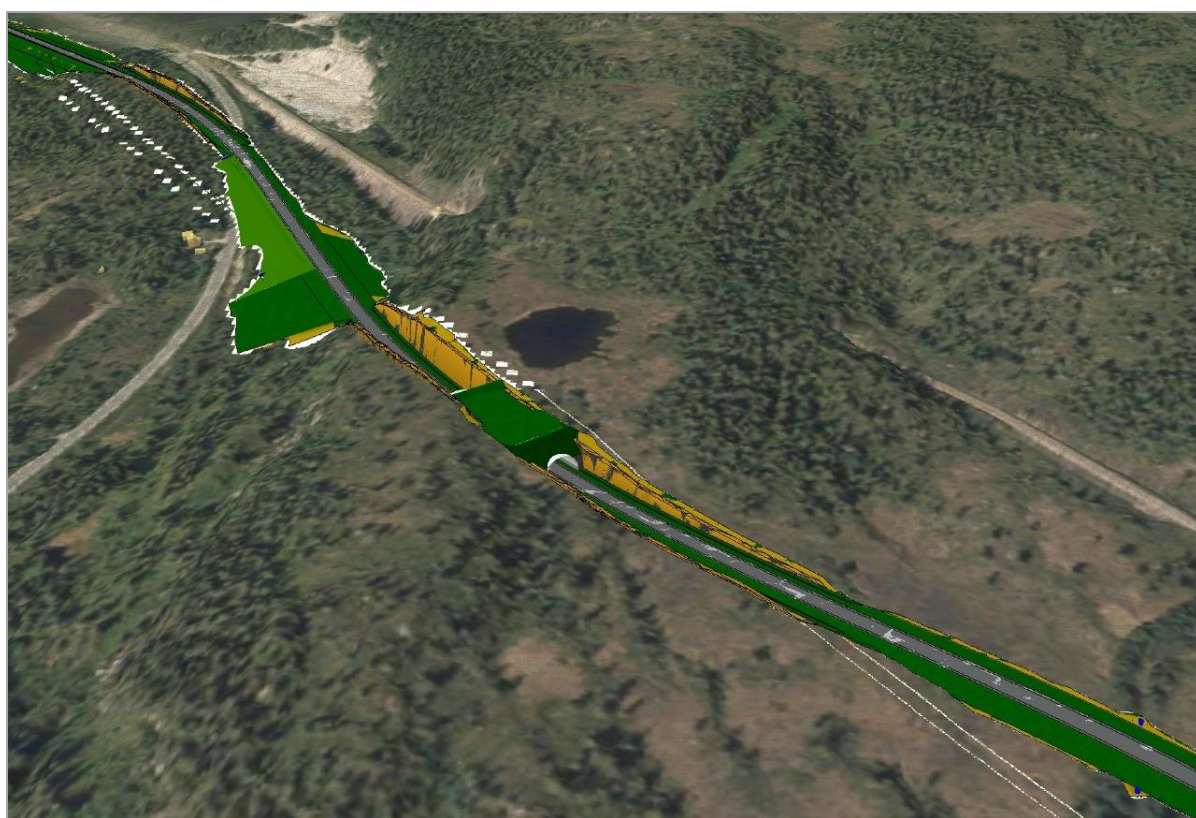
Figur 6-7. Utsnitt fra prosjekteringsmodellen hentet fra søknaden om omlegging av flyttleia (Statens vegvesen, 2020b) som viser økoduktens plassering litt sør for toppen av landskapsryggen, hvor flyttleia opprinnelig gikk. Jernbanetunnelen rett øst for tjernet er en naturlig landskapspassasje over Nordlandsbanen. Sammen legger overgangene til rette for at reinen kan krysse E6 og jernbanen planfritt.
