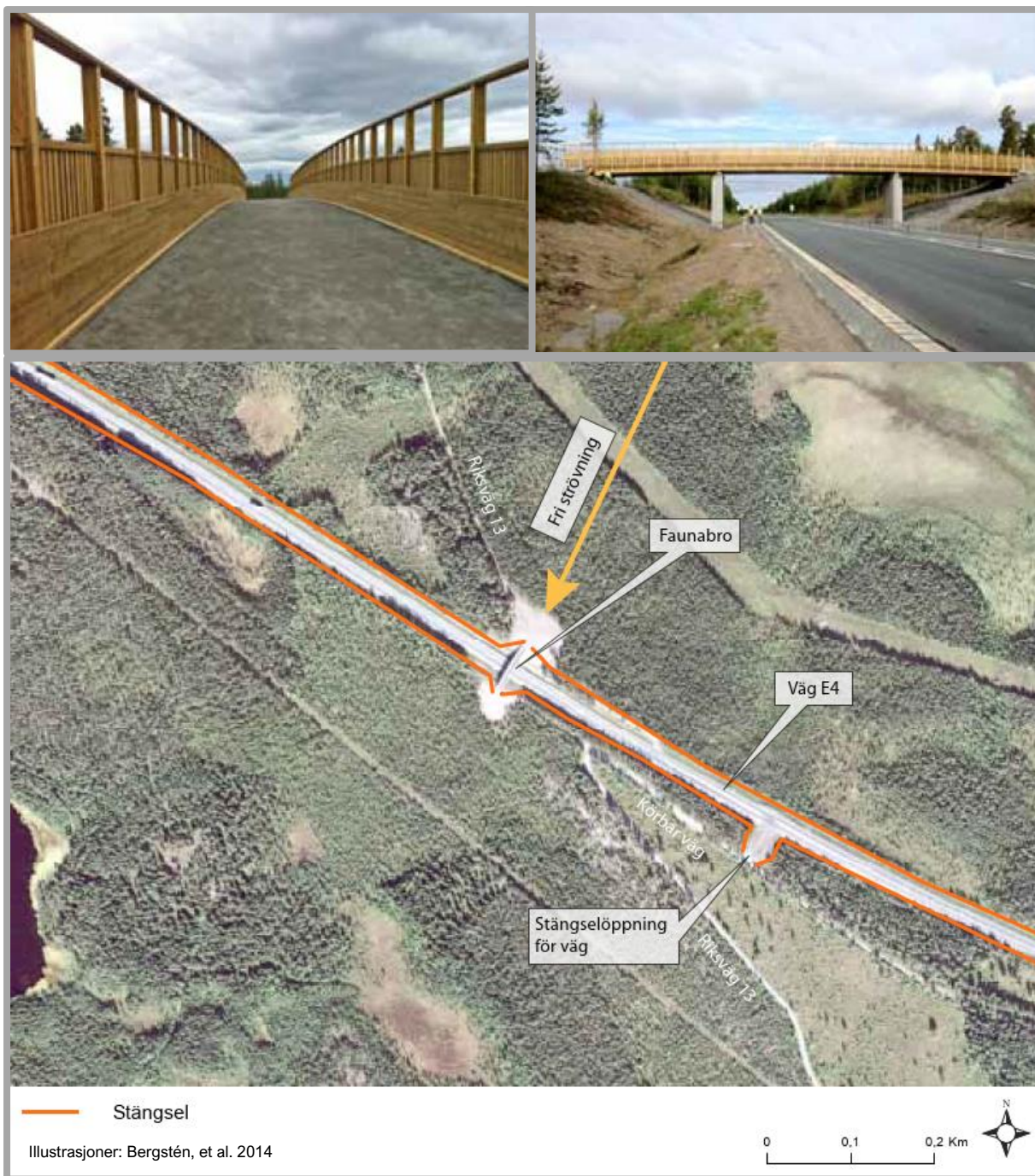
Figur 5-11. Illustrasjon av faunaovergang ved Harrioja hentet fra Bergstén et al. (2014). Passasjen er smal og lang, med høye rekkverk i tre langs sidene. Flyfotoet fra 2013 viser omgivelsene til faunaovergangen og den nærliggende åpningen i viltgjerdet. I begge endene av overgangen er det åpne flater uten vegetasjon. (Kilde: Bergstén, et al. 2014)
